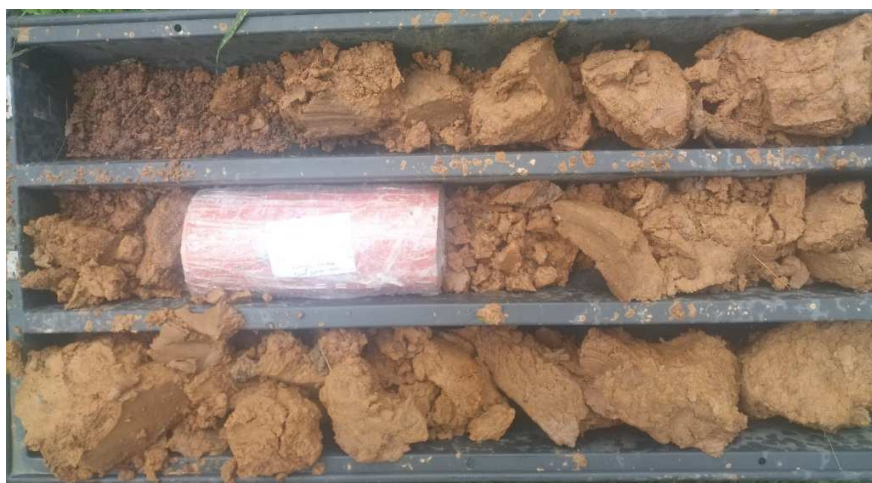
Foto 5: Jádro z hydrogeologického vrtu 0-3 m
