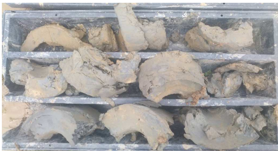
Foto 9: Jádro z hydrogeologického vrtu 12-15 m
