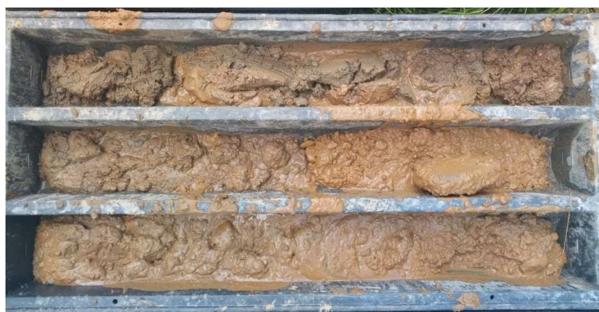
Foto 7: Jádro z hydrogeologického vrtu 6-9 m
