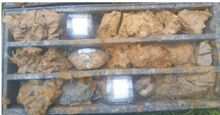
Foto 6: Jádro z hydrogeologického vrtu 3-6 m
