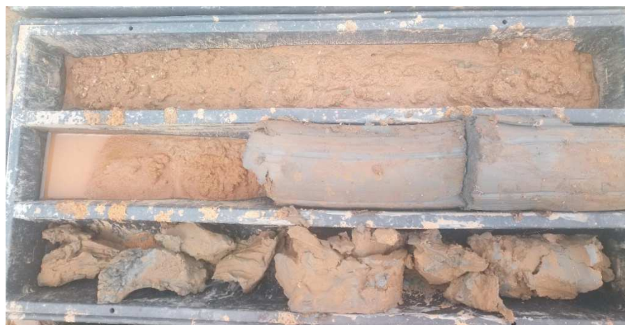
Foto 8: Jádro z hydrogeologického vrtu 9-12 m
